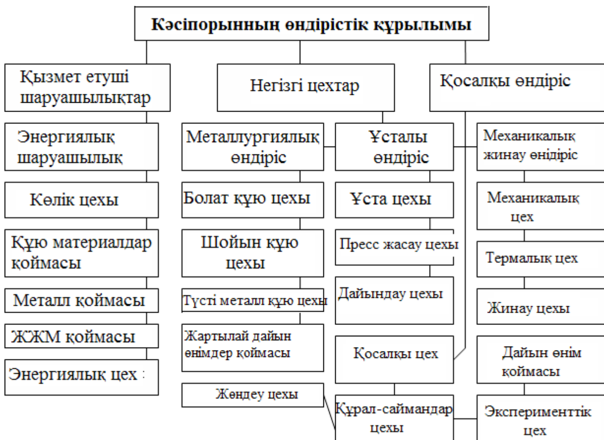
Сурет 2 – Ірі машина жасау зауытының өндірістік құрылымының сызбасы
