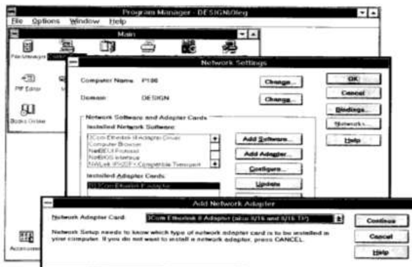
Сурет 5. Windows NT Server желілік адаптер платасын орнату.
