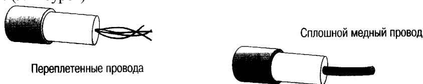
Сурет 4. Жіп– өрілген өткізгіштер немесе тұтас мыс өткізгіш
