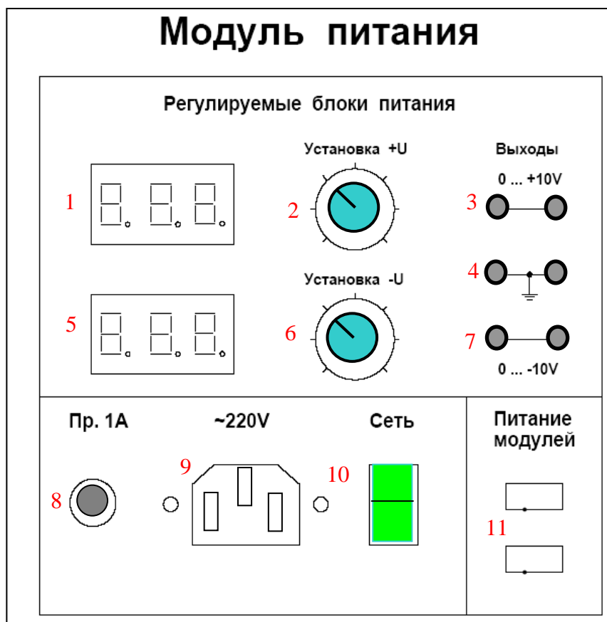
Рис. 1.2. Вид панели «Модуль питания» базового блока. Здесь цифрами красного цвета обозначены:
