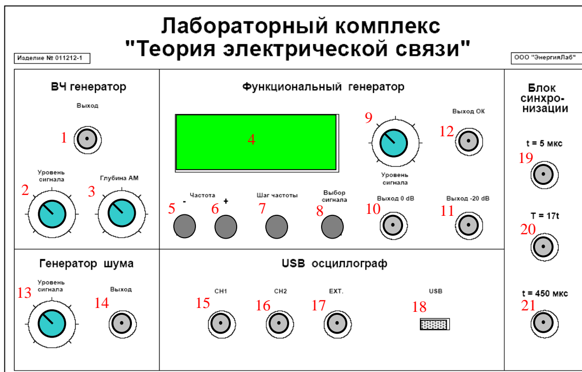
Рис. 1.3. Вид панели Генераторного и измерительного модуля. Здесь цифрами красного цвета обозначены:
